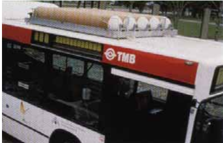
Detalle de los depósitos de combustible situados en el techo del vehículo.
