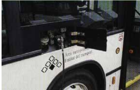
Toma de carga del gas natural comprimido de los autobuses.
