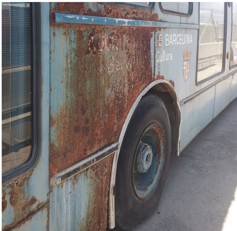
Imatge 49: Localització de les barres metàl·liques inferiors
