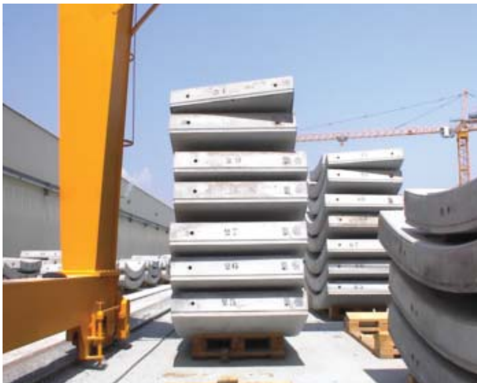
Dossers baldaquins de revestiment del túnel.
