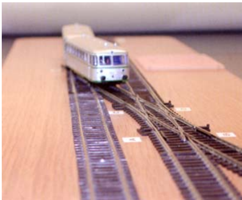
La travessia d'unió doble és una intersecció entre dues vies rectes obliqües més unes agulles que les connecten entre sí.
