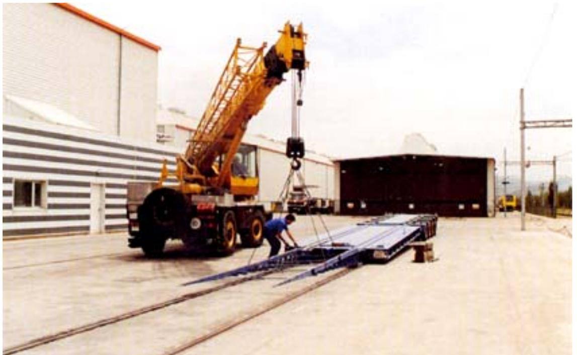
Las góndolas, especiales para el transporte de material ferroviario, se sitúan en posición inclinada, perfectamente orientadas sobre la vía de carga.
