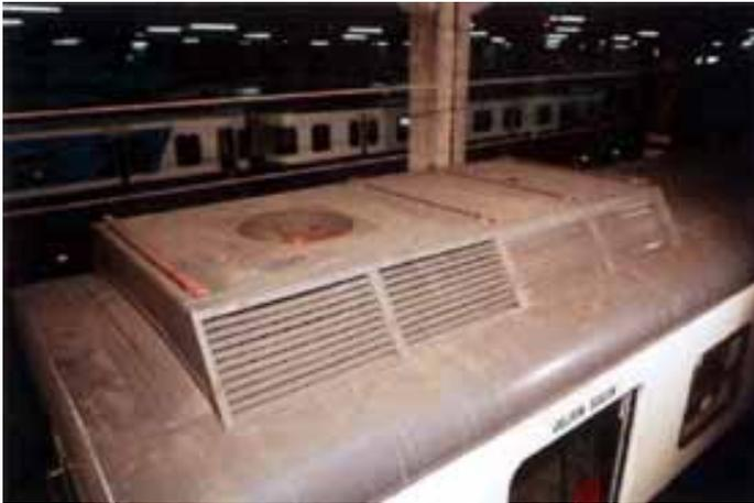
Equipo de aire acondicionado Faiveley ya instalado, semiempotrado en el techo de un coche S/1000. Pueden observarse las tiras de material aislante que fue necesario instalar para evitar esporádicos contactos con la catenaria al quedar los equipos al límite del gálibo. Foto Faiveley.
