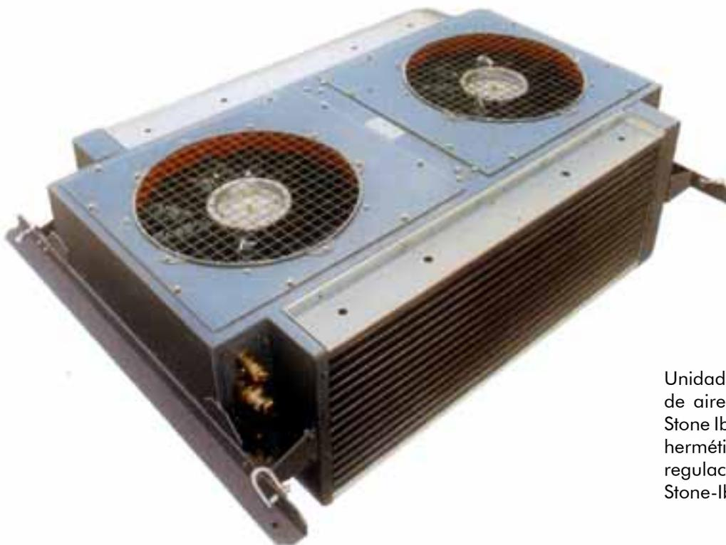
Unidad condensadora UC-002 del equipo de aire acondicionado, tipo dispersos, de Stone Ibérica. Incorpora un compresor semihermético de 6 cilindros con descarga para regulación de capacidad en 4 de ellos. Foto Stone-Ibérica, S.A.
