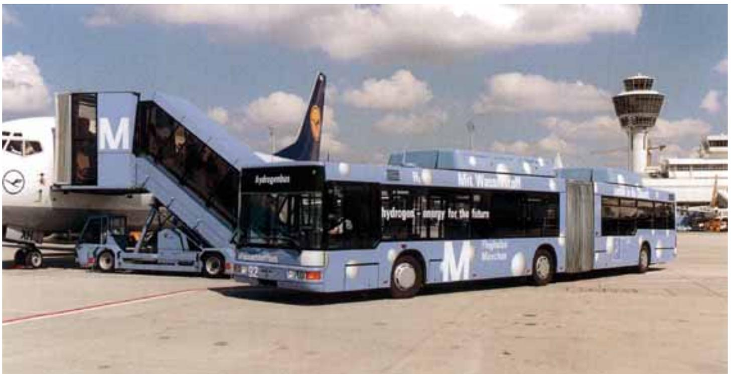
La primera experiència d'utilització d'hidrògen com a carburant: La prova de l'aeroport de Múnic, autobusos articulats amb motors d'explosió.
