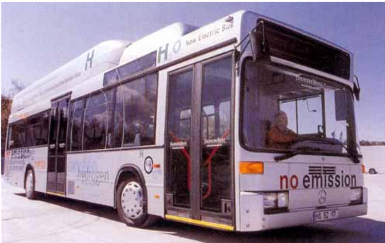
L'autobús a pila de combustible NEBUS de Daimler-Crysler.
