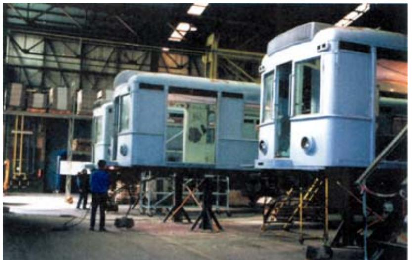
Reparación y restauración general de cajas apoyadas sobre caballetes. Simultáneamente se procedió a reparar bogies, enganches y equipos eléctricos y neumáticos.
