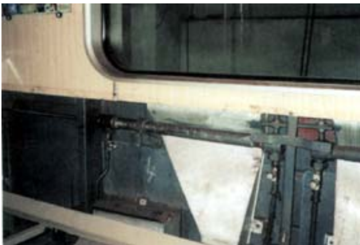
Nou sistema i màquina de portes montada en un cotxe del Metro de Kíev.
