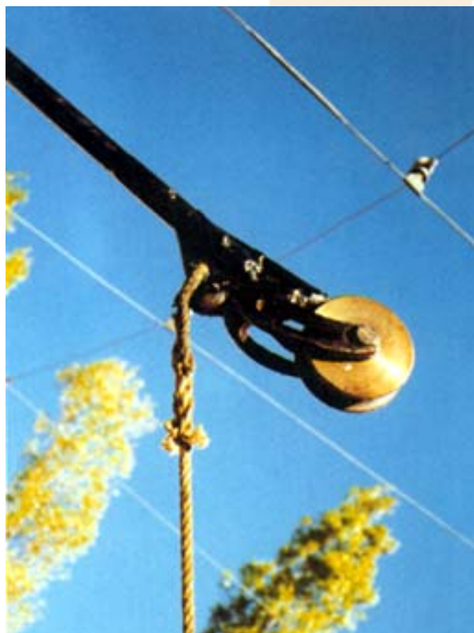
Detalle de la línea aérea y el trolley abatido del tranvía núm. 5
