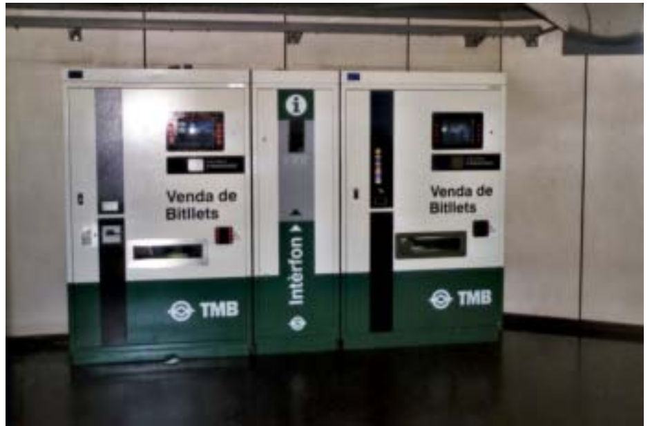
Máquinas automáticas de venta de billetes, junto con un puesto de información con conexión directa al centro de control. José Luis. (20/2/00)
